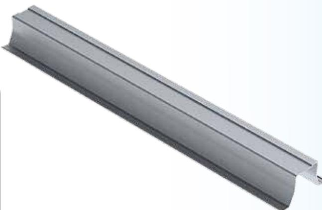
O painel de laje é fabricado com perfis de liga de alumínio da série Magnésio-Silício, têmpera 6 e/ou com chapa de alumínio da série Magnésio com tratamento de têmpera de encruamento, para aumentar suas propriedades e trazê-lo à sua condição original.
