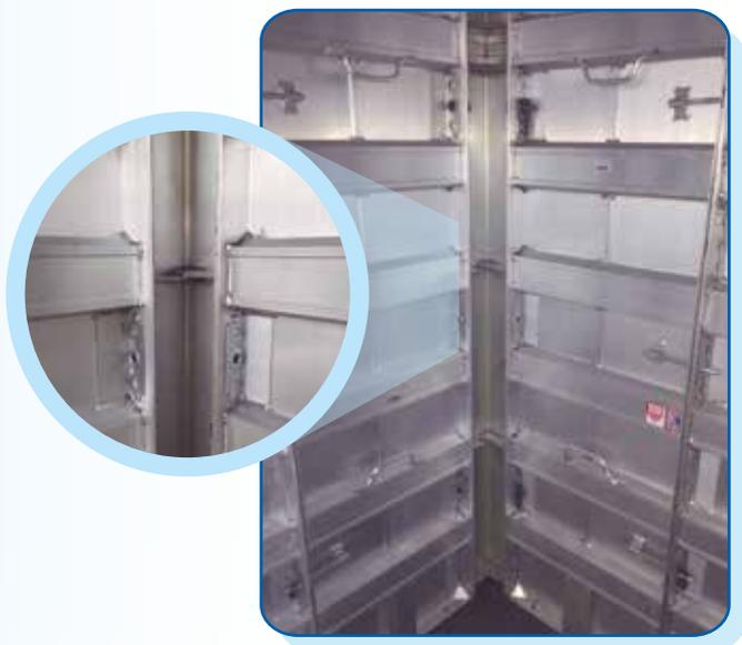
Para facilitar a desmoldagem dos painéis de parede-laje, o canto interno é modulado em 2 seções; a parte superior cobre a junção parede-laje até a primeira perfuração do painel de parede e a parte inferior cobre o resto do comprimento do painel de parede.
