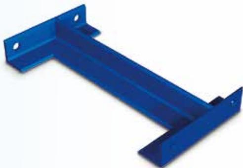
\*Quando o vão da porta não possui verga superior, recomenda-se a instalação de 2 tensores, um na parte superior e outro na parte inferior. É utilizado para vãos de no máximas de 1,80 m.
